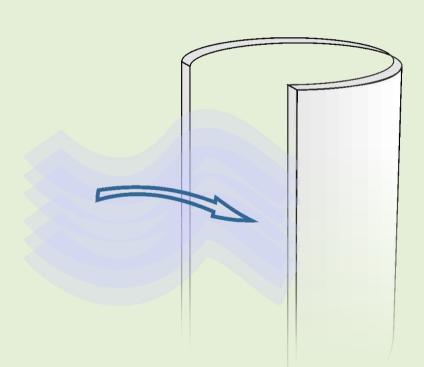
WAVE GRASPER: U-SHAPED CONSTRUCTION CATCHING THE WAVES
